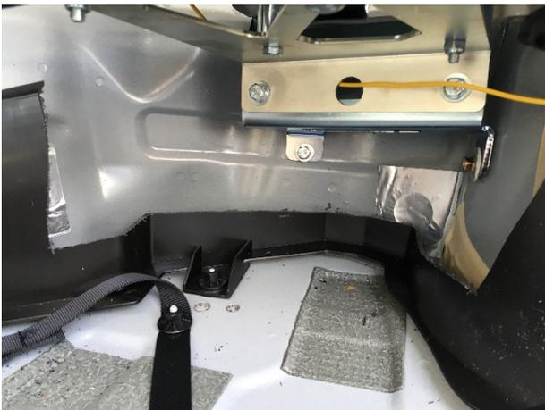
Bild 7: Befestigung an Spritzwand unten
